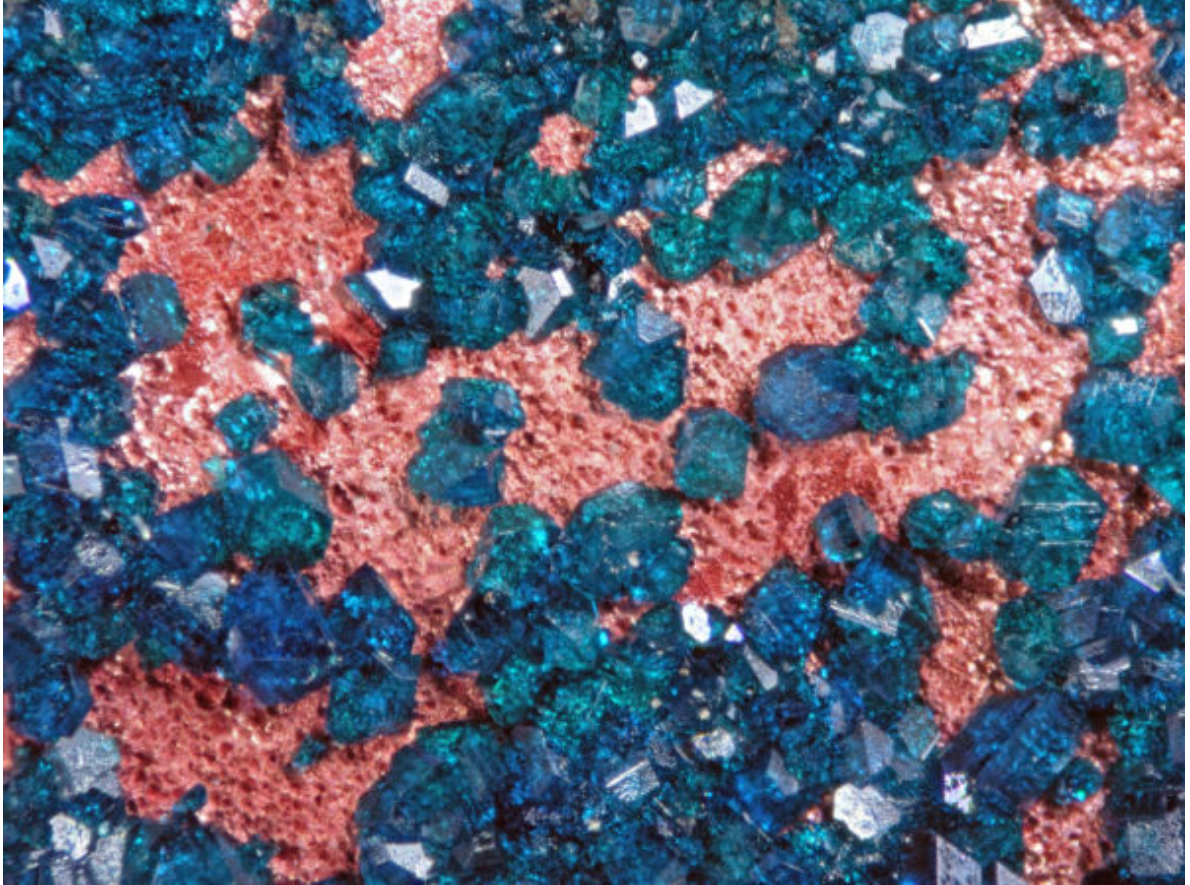
Hoganita sintética fabricada por nosotros, sobre un fragmento de cobre. Compárese con la imagen de la muestra de Bou Nahas.
